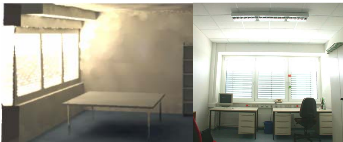
Bild 2-14: Tageslichtlenkung in einem südorientierten Büroraum – Simulation und Realität
